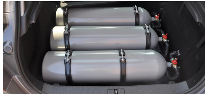
Foto 1: Inbouw CNG-systeem in kofferbak.
