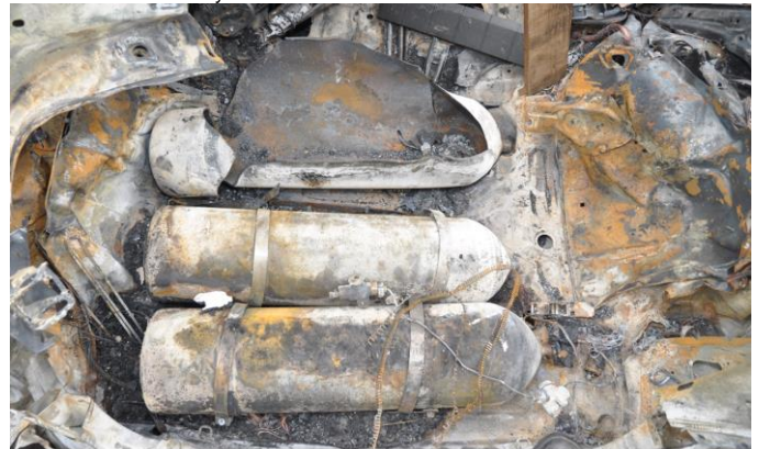
Foto 2: Soortgelijke inbouw na bezwijken. Let op rechter zijpaneel.
