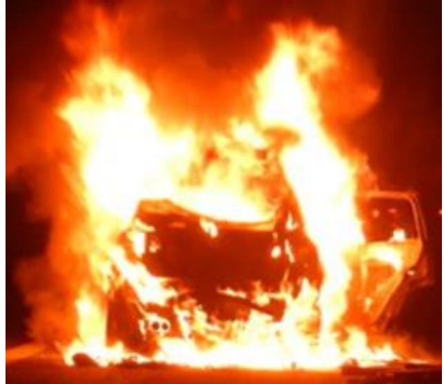
Foto 6: Vuur intensiveert plots door aflazen tank
